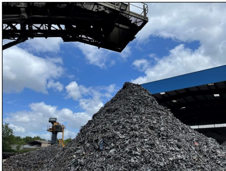
Ferrailles 33/40 (refus positif) issues du séparateur magnétique en aval de la ligne de broyage
